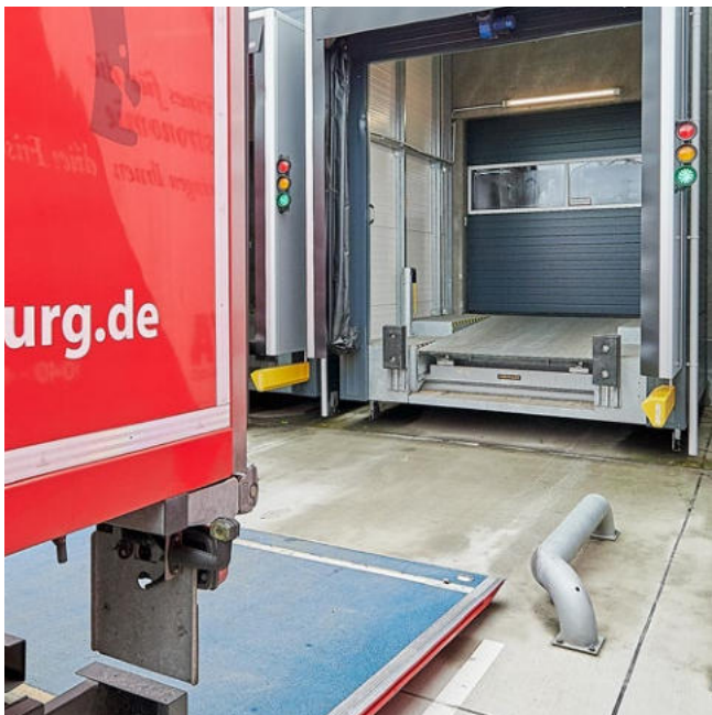
Navođenje kotača i podrška na pretovarnom mjestu DAP
